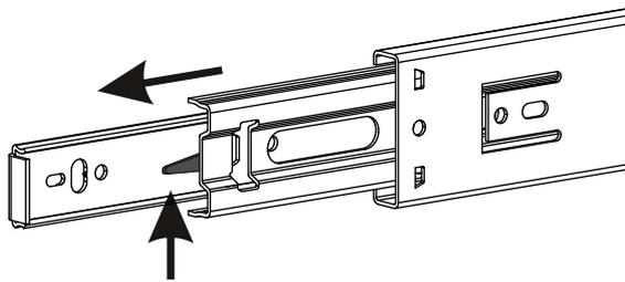
Для разъединения направляющих на две части, требуется нажать на пластиковый рычажок, предварительно выдвинув узкую часть до упора.
